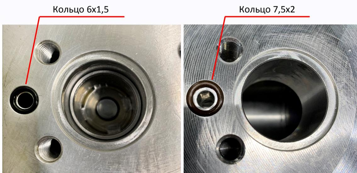
**Рисунок 4 – Установка уплотнительных колец 6x1,5 и 7,5x2.**
