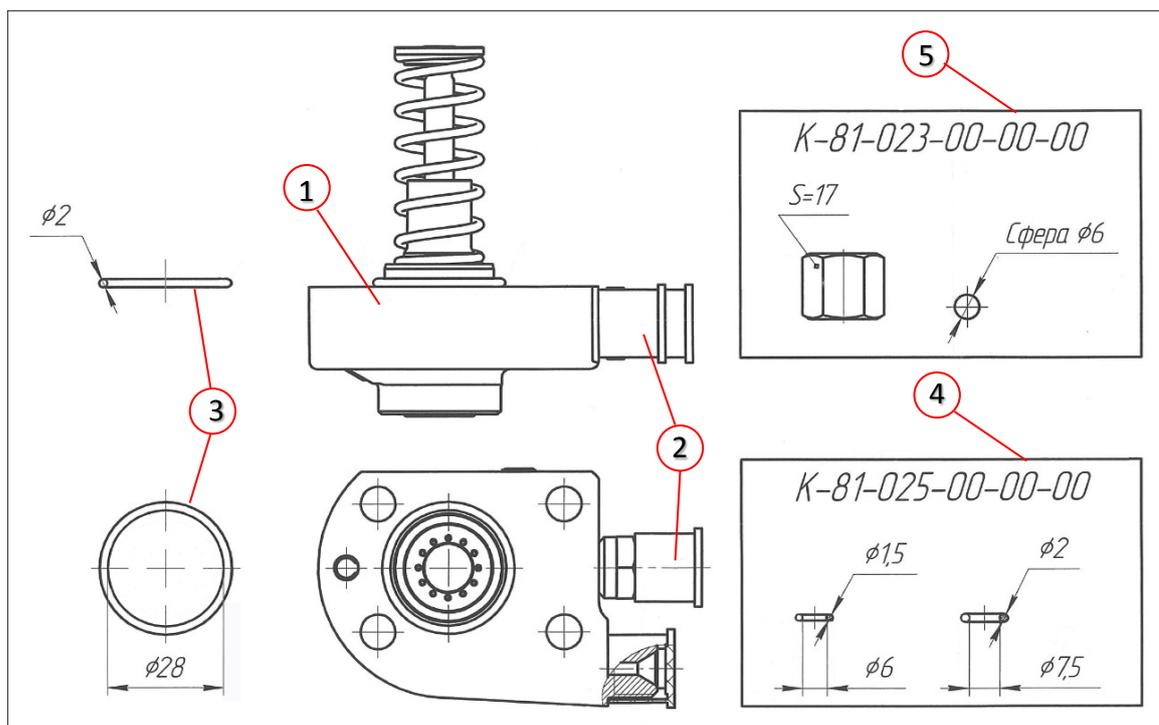
**Рисунок 3 - Состав ремонтного комплекта К-81-014-00-00-01.**
